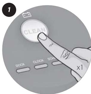
Отсоединить робот-пылесос Roomba от док-станции Home Base®. Включить робот-пылесос нажатием кнопки CLEAN. Загорится световая индикация.
